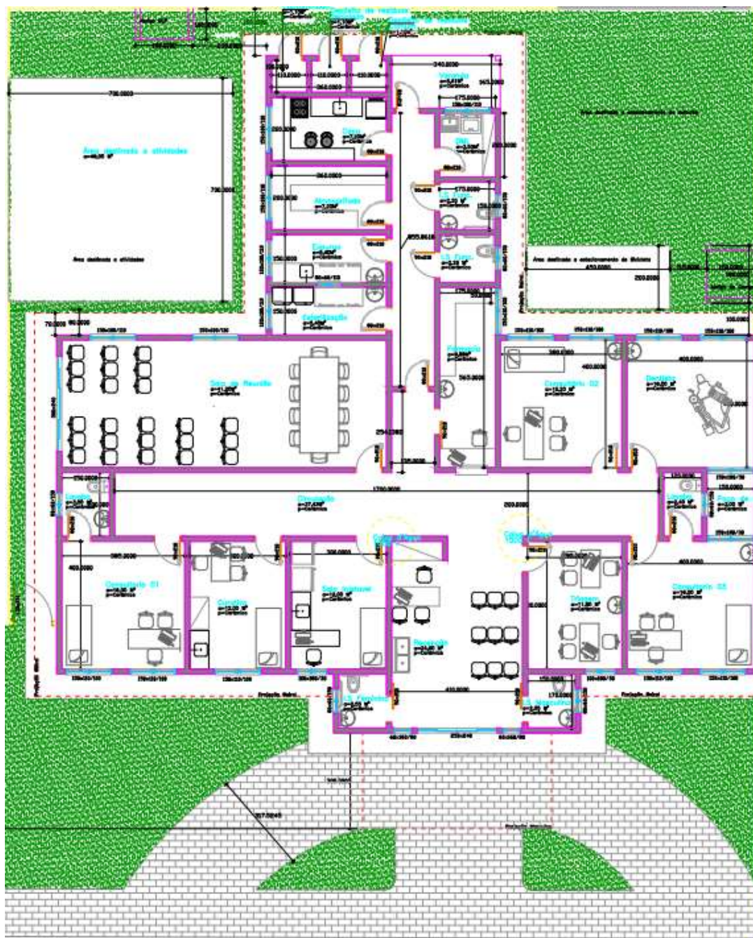
PLANTA BAIXA POSTO DE SAÚDE - MUNDO NOVO ÁREA A CONSTRUIR= 307,49 M 2 ESC.: 1/100
